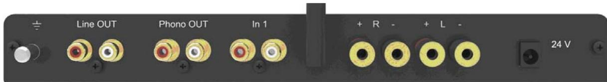
Nehmen Sie Anschlüsse und das Trennen von Anschlüssen **nur** bei **vom Netz getrenntem Gerät** vor. Schließen Sie pro Kanal nur einen Lautsprecher mit einer Impedanz nicht unter 4 Ohm an.
