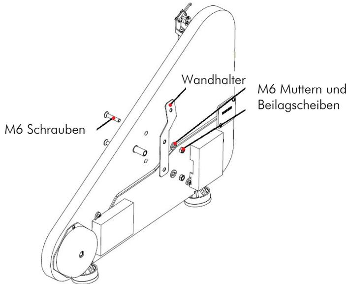
Um die beiden unteren Wandhalter montieren zu können, müssen die beiden Gerätefüße demontiert und die Halter mit den beiden Befestigungsschrauben der Gerätefüße mit dem Chassis verschraubt werden.
