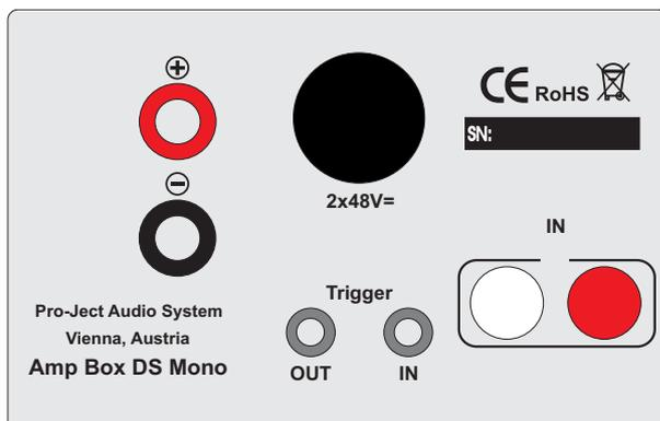
Nehmen Sie Anschlüsse und das Trennen von Anschlüssen **nur bei vom Netz getrennten Gerät** vor. Schließen Sie nur einen Lautsprecher mit einer Impedanz nicht unter 4 Ohm an.
