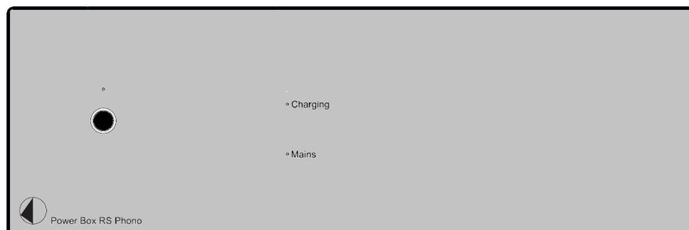
Der Schalter links an der Gerätefront schaltet die Versorgungsspannung von 2x18V ein und aus. Die blaue Leuchtanzeige über dem Schalter zeigt an, dass der Ausgang eingeschaltet ist.
