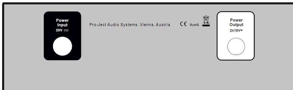
Verbinden Sie mit dem beiliegenden Versorgungskabel die Netzteilbuchse und die Ausgangsbuchse (20V).
