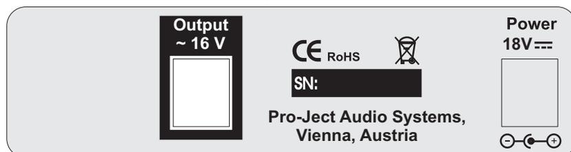
Verbinden Sie mit dem beiliegende Versorgungskabel \*\*\* die Buchse **Output ~16V** und die Netzteilbuchse ihres Plattenspielers. Das vorhandene Steckernetzteil des Plattenspielers wird nicht mehr benötigt.
