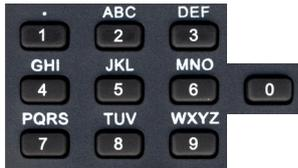
Ziffern- und Buchstaben-Tasten. Sie werden zur Suche von Menüelementen auf Medienservern, Internet-Radiostationen und zur Eingabe von Einstellungen benutzt. Sie funktionieren vergleichbar mit den entsprechenden Tasten bei Mobiltelefonen.
