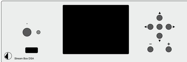
Mit der Taste auf der linken Seite schalten Sie das Gerät ein und bringen es wieder in den Bereitschaftsbetrieb (Stand-By) zurück. Die LED oberhalb der Taste leuchtet blau, wenn das Gerät eingeschaltet ist. Die USB-Buchse links hat die gleichen Eigenschaften wie die auf der Rückseite.
