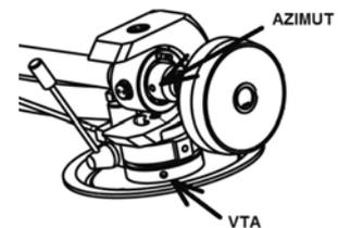
Dazu stellen Sie das Geodreieck mit seiner Basislinie auf den Plattenteller und richten die Oberkante des Tonabnehmergehäuses an den Parallellinien aus.
