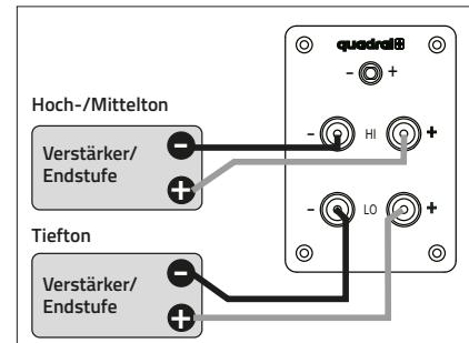
Beim Bi-wiring / Bi-amping Betrieb der **AURUM** Lautsprecher befinden sich die beiden Schraubklemmen für den Tieftöner (LO) unten und die für den Mittel- und Hochtoner (HI) oben auf der Anschlussplatte. Nur die größten Modelle der **AURUM 9** Reihe verfügen über ein erweitertes Anschlussfeld, bei dem diese Anschlüsse horizontal angeordnet sind und die verschiedenen Betriebsarten mit der Zuordnung von (HI) und (LO) sinngemäß gelten.
