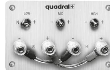
Dans ces modes de fonctionnement, observez impérativement la polarité correcte et veillez à retirer les cavaliers sur le bornier des haut-parleurs pour éviter tout risque d'endommagement de votre amplificateur.
