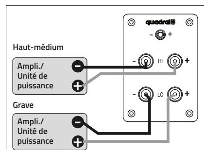
Si les haut-parleurs **AURUM** sont utilisés en mode Bi-wiring / Bi-amping, les deux raccords vissés pour les basses (LO) se trouvent au-dessous de la plaque de raccordement et ceux pour les médiums et les tweeters (HI) au-dessus.
