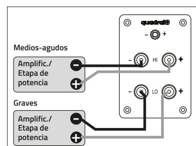
En el funcionamiento del bicableado / de la biamplificación del altavoz AURUM se encuentran bornes con tornillos para las frecuencias graves (LO) en la parte inferior y para las frecuencias medias y altas (HI) en la parte superior, en la placa de conexión.
