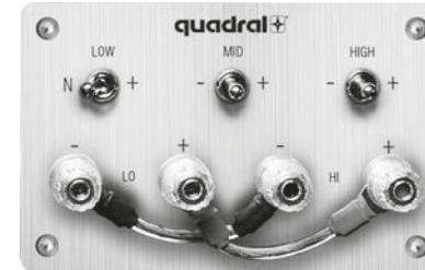
Achten Sie in diesen Betriebsarten unbedingt auf die Einhaltung der korrekten Polung und darauf, dass Sie die Brücken am Lautsprecherterminal entfernen, da es sonst zu Beschädigungen an Ihrem Verstärker kommen kann.
