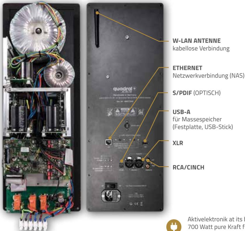
Echte deutsche Präzisionsarbeit: Die geballte Power und ausgeklügelte Steuerung sind die zentralen Merkmale der neuen AURUM Aktiv-Elektronik. Beide Modelle schöpfen ihre Kraft aus Class-D Hochleistungsverstärkern für den Tiefton- und Mitteltonbereich. Für den Hochtöner werden musikalische Analogendstufen eingesetzt. Die Gesamtleistung beträgt bei der AURUM GAMMA 350W@1% THD je Lautsprecher.
