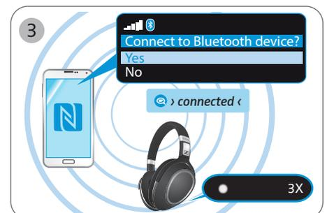
**i** Wenn keine Verbindung hergestellt wird, hören Sie die Sprachmeldung „Kein Gerät gefunden“. Wenn innerhalb von 5 Minuten keine Verbindung hergestellt werden kann, wird der Paarungsmodus beendet und der Kopfhörer kehrt in den unverbundenen Zustand zurück. Starten Sie den Kopfhörer neu, indem Sie ihn aus- und wieder einschalten und wiederholen Sie den Paarungsvorgang.
