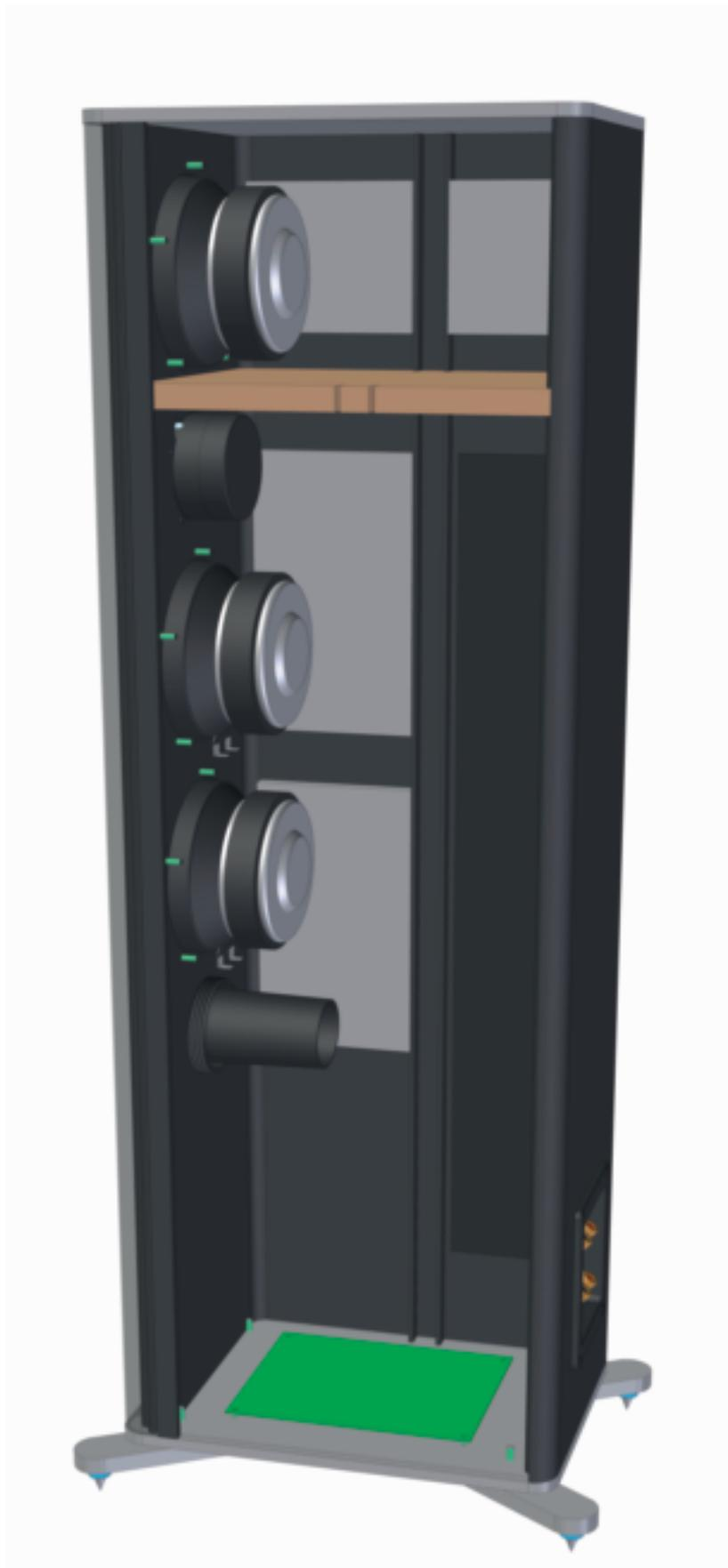
Die CAD-Konstruktionszeichnung zeigt den inneren Aufbau der KS 300. Der Mitteltöner arbeitet in einer eigenen, luftdichten Kammer, die durch eine MDF-Platte vom Gehäuse abgetrennt ist. Dies bedämpft zusammen mit weiteren Platten die Gehäusewände bestens. Die beiden Tieftöner haben ein relativ großes Volumen zur Verfügung und können so sehr tief abgestimmt werden. Ein Bassport unterstützt die Abstrahlung tiefster Frequenzen.
