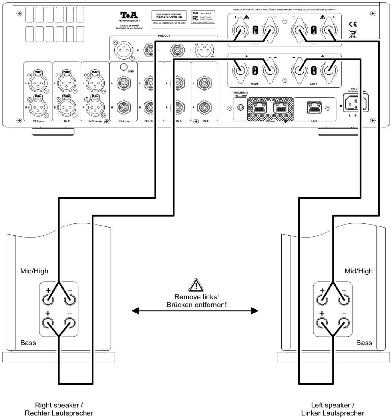
**i** Für den Bi-Wiring Betrieb gibt es einen speziellen Bi-Wiring Modus. Dieser schaltet die Lautsprecherausgänge A und B gleichzeitig über die Taste ein und aus. Siehe hierzu Kapitel '**Grundeinstellungen des PA 2500 R**'.
