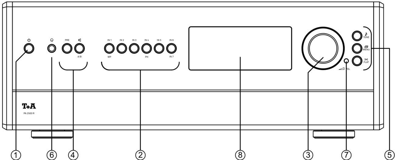
Mit den Tasten an der Gerätefront können alle wichtigen Funktionen des **PA 2500 R** bedient werden. Für die grundlegenden Funktionen wie die Quellenwahl stehen direkte Bedientasten zur Verfügung, seltener benötigte Funktionen werden über Menüs bedient, die über die **MENU** / **TONE** Tasten aufgerufen werden.
