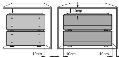
Es dürfen keine wärmeisolierenden Gegenstände (z. B. Decken oder andere Geräte mit ebener Bodenplatte ohne Standfüße) direkt auf das Verstärkergehäuse gestellt werden.
