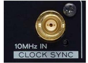
Dank Unterstützung eines externen 10-MHz-Master-Taktsignaleingangs ist zudem die Synchronisierung mit noch präziseren Taktsignalen möglich. Die Synchronisierung mit einem noch präziseren Taktsignal macht sich mit einer spürbar höheren Ton- und Audioqualität bezahlt.
