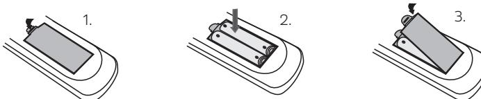
2. Legen Sie 2x AAA 1,5V Batterien unter Berücksichtigung der Polung in die Fernbedienung ein. Die Ausrichtung ist im Batteriefach abgebildet.
