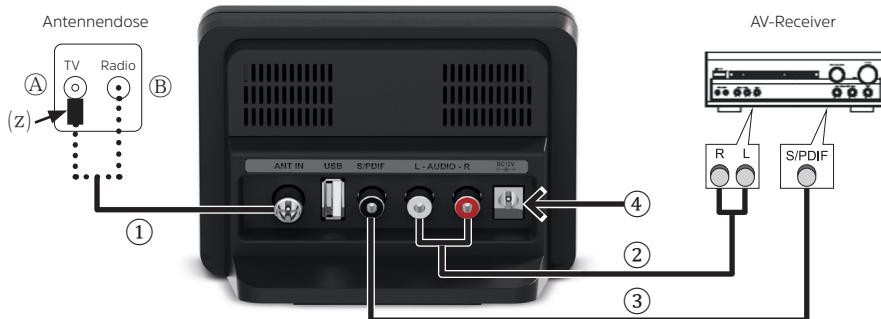
① ANT IN: Verbinden Sie den Antenneneingang des **CABLESTAR 100** mit der Antennendose um das Gerät mit dem Kabelsignal zu verbinden. Verwenden Sie hierfür beiliegendes Antennenkabel.
