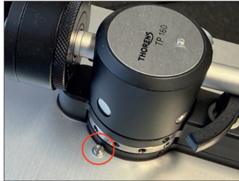
Fig. 24 Justageschraube für die Endabschaltung
