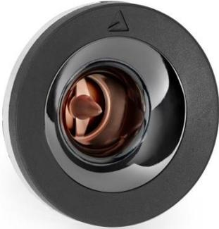
Seit vielen Jahren vertraut TRIANGLE in den gehobenen Serien die Wiedergabe der hohen Töne einem Hornhochtöner an. Zunächst wird eine Magnesium-Membran vom Verstärkersignal in Schwingung gebracht. Der dann abgestrahlte Schall erfährt durch den vorgesetzten Schalltrichter – das Horn – eine sehr deutliche Steigerung des Wirkungsgrades. So werden auch feinste Verästelungen des Signals deutlich und dynamisch übertragen.
