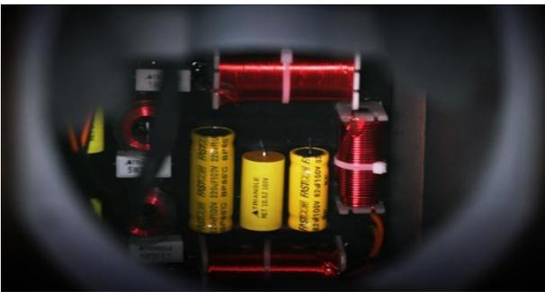
Um jedem Chassis einen optimalen Arbeitsbereich zuzuweisen verfügt die ANTAL 40th über eine Frequenzweiche mit höchst selektierten Bauteilen. Jede Komponente wird sorgfältig ausgewählt: Luftkernspulen, MET-Kondensatoren und Keramikwiderstände.
