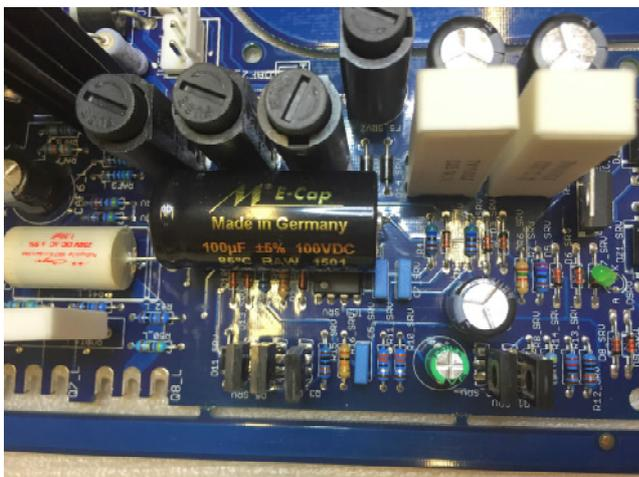
Alle Kondensatoren im Signalweg haben niedrige Verluste und ausgezeichnete Eigenschaften bei hohen Frequenzen. In dieser Hinsicht sind Polypropylen-Kondensatoren besonders geeignet.
