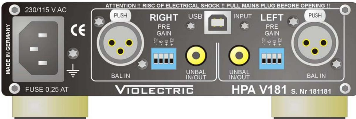
Der **OPTO** Eingang erwartet an seiner Tos-Link Schnittstelle digitale Audiodaten mit einer Sample Rate zwischen 28 ... 108 resp. 210 kHz. Am **USB** Eingang vom Typ "B" kann ein Host (PC oder Lap-Top) angeschlossen werden. Die USB Baugruppe wird automatisch als Audiogerät erkannt.
