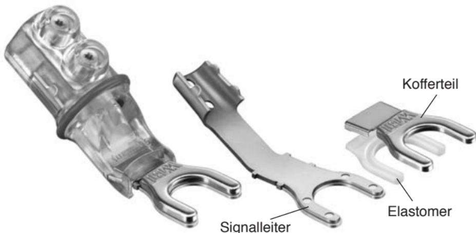
Das Sandwich-Prinzip garantiert zudem einen extrem hohen und progressiven Kontaktdruck: Sowohl WBT-0661 als auch WBT-0681 sind geeignet für 100 A Dauerstrom (I<sub>s</sub> 1.000 A!). Sie zeichnen sich zudem durch einen besonders festen Sitz in der Polklemme aus.
