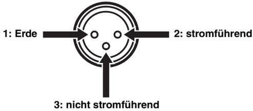
Beim Anschließen vergewissern Sie sich, dass die Pins richtig angesetzt sind und stecken Sie den Steckverbinder des „weiblichen“ symmetrischen XLR-Kabels vollständig ein. Beim Abziehen ziehen Sie das „weibliche“ symmetrische XLR-Kabel heraus, während Sie die Verriegelung am Stecker gedrückt halten.
