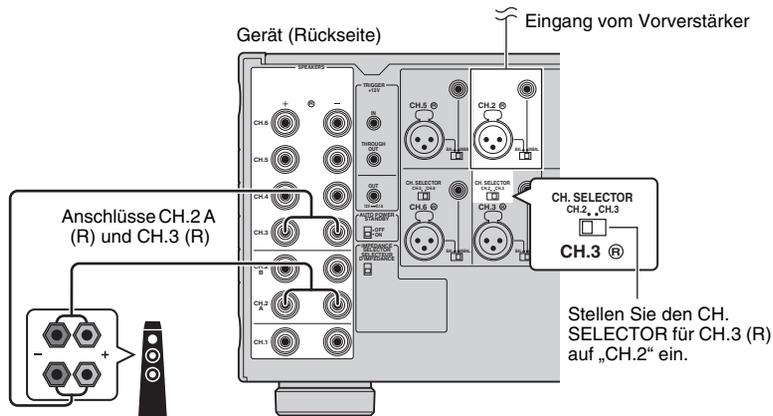
Durch Einstellen des CH. SELECTOR für CH.3 (R) auf „CH.2“ werden die Eingangssignale von CH.2 (R) sowohl auf CH.2 (R) als auch auf CH.3 (R) ausgegeben. In diesem Fall wird der Eingang CH.3 (R) nicht verwendet.
