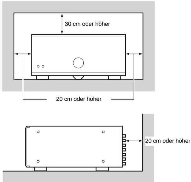
Da das Gerät blanke metallene Lautsprecheranschlüsse besitzt, sorgen Sie für ausreichend Platz an der Geräterückseite. Wenn die Lautsprecheranschlüsse mit Metallteilen Ihres AV-Regals o. ä. in Kontakt kommen, wird das Gerät kurzgeschlossen und beschädigt.
