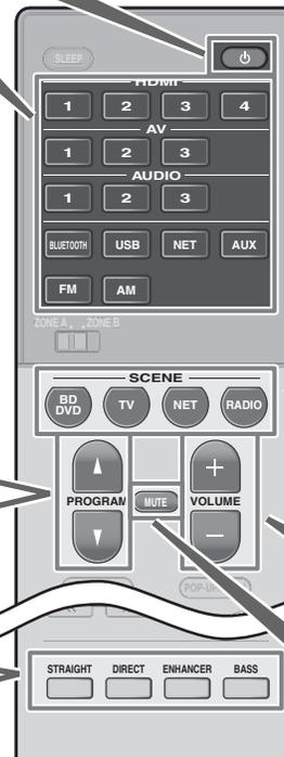
Geräte-Eingangsquellen und -Einstellungen, die den Tasten SCENE zugewiesen worden sind, können mit einem einzigen Druck ausgewählt werden (SCENE-Funktion).
