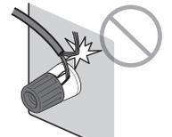
Falls nach dem Einschalten des Geräts „Check SP Wires“ auf dem Frontblende-Display angezeigt wird, schalten Sie das Gerät aus, und überprüfen Sie die Lautsprecherkabel dann auf einen möglichen Kurzschluss.
