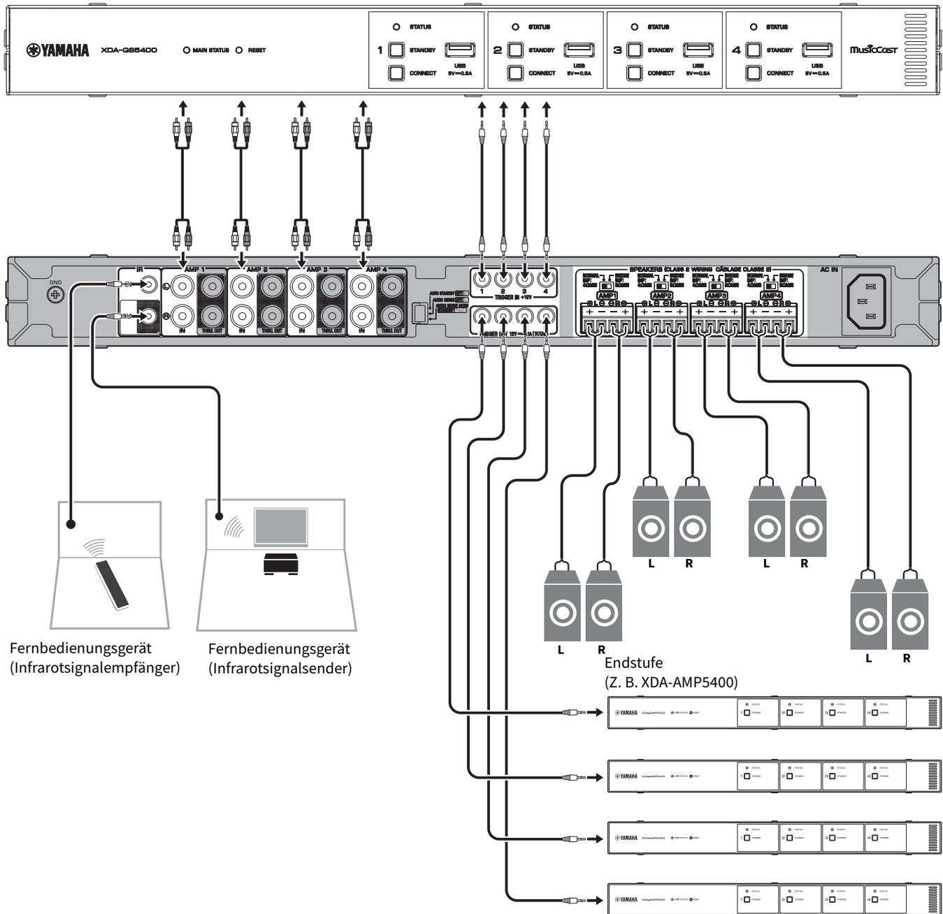
Dieses Gerät besitzt keine Lautstärkeregelung. Achten Sie darauf, an diesem Gerät ein Gerät mit Lautstärkeregelung anzuschließen (z. B. einen Vorverstärker). Wenn Sie ein Gerät ohne Lautstärkeregelung (z. B. einen CD-Player) direkt an diesem Gerät anschließen, kann die Lautstärke extrem hoch sein und das Gerät oder die Lautsprecher beschädigen.
